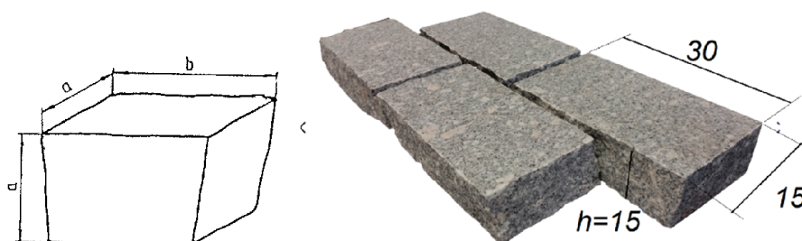
Rysunek 1. Kształt kostki (15x15x30cm)
